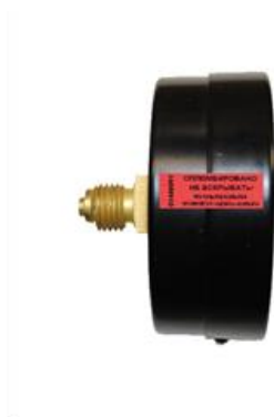
а) Место пломбировки с помощью наклейки
