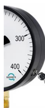
б) Место пломбировки с использованием пломбы
